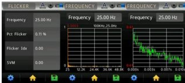
Fig. 83: Zum Vergleich: Tageslicht im Freien vor Stadthalle, Flimmern (Flicker) so gut wie nicht vorhanden mit 0,11% , Frequenzbereich ca.25Hz
