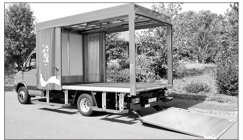
Die Plane ist so schnell geöffnet wie sie geschlossen werden kann – denn Zeit ist Geld. Mit dem neu entwickelten Spier-Schiebeplanen-Aufbau ist zugleich eine höhere Ladungssicherung verbunden.
